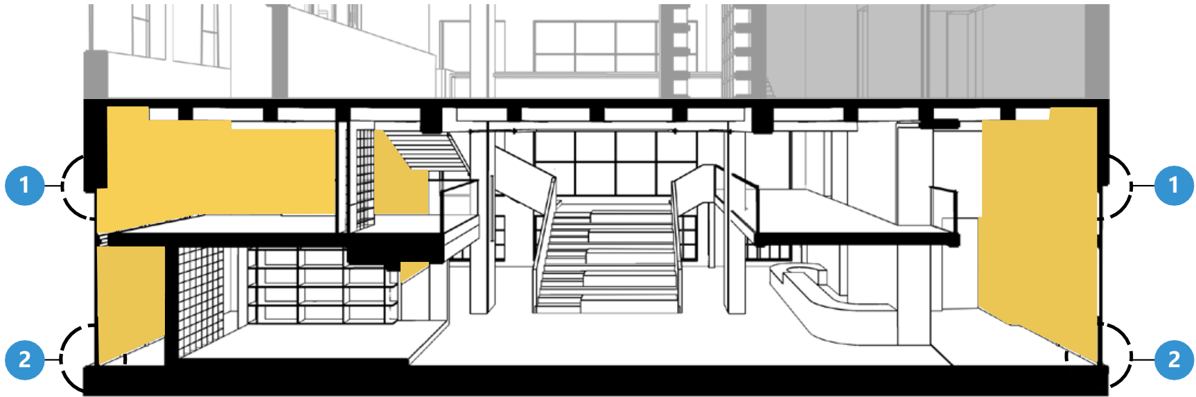
新建墙壁，改善入口处的隔热效果
